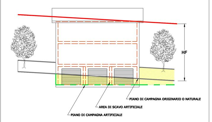
TUTTA LA PARTE ARTIFICIALMENTE SCAVATA CHE SI TROVA SOTTO LA LINEA NATURALE/ORIGINARIA DEL TERRENO NON VIENE COMPUTATA PER L'ALTEZZA DEL FRONTE.
