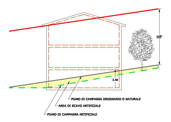
TUTTA LA PARTE ARTIFICIALMENTE SCAVATA CHE SI TROVA SOTTO LA LINEA NATURALE/ORIGINARIA DEL TERRENO NON VIENE COMPUTATA PER L'ALTEZZA DEL FRONTE.
